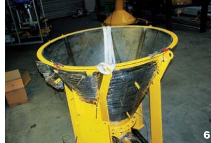
Silobeheizung (1), Kesselanlage für ein deutsches Kraftwerk (2), für eine 10-MW-P2H-Anlage werden ca. 500 Heizelemente eingelötet (3), Notruf-Alarmsystem mit Wake-on-LAN-Funktion (4), beheizter Tankaufleger (5), Trichterheizung mit Mi-Heizkabeln (6)
